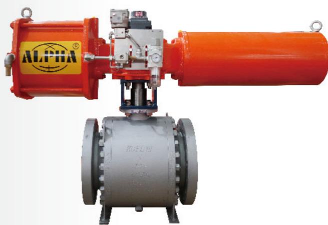
气源接口前后对称分布，便于附件面板的安装和管路的连接，两只气口可满足客户对于动作速度的需求，并可提供多种管螺纹的气源接口；吊环螺钉按整体重心分段设置，便于执行机构的吊装，吊环螺钉采用达克罗工艺防腐亮化处理，外形美观，操作简单方便。
